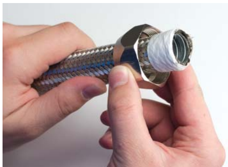
1. Вначале следует надеть на металлорукав зажимную гайку
